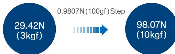
Loading test force 試験力負荷
